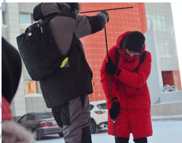
Измерение глубины щупом мощности снега
