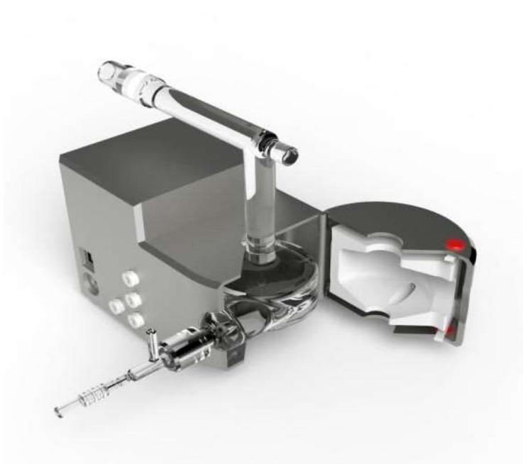
Система управления охлаждением камеры распыления с дверцей проста в сборке.
