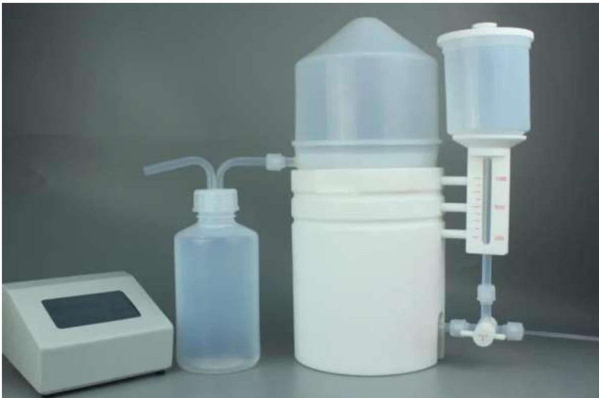
Система получения ультрачистых кислот. Может очищать почти все виды кислот. Все компоненты системы изготовлены из сверхчистого полифторацетата.
