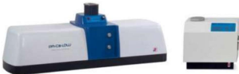
Лазерный анализатор размера частиц сухой дисперсии сжатым воздухом.
