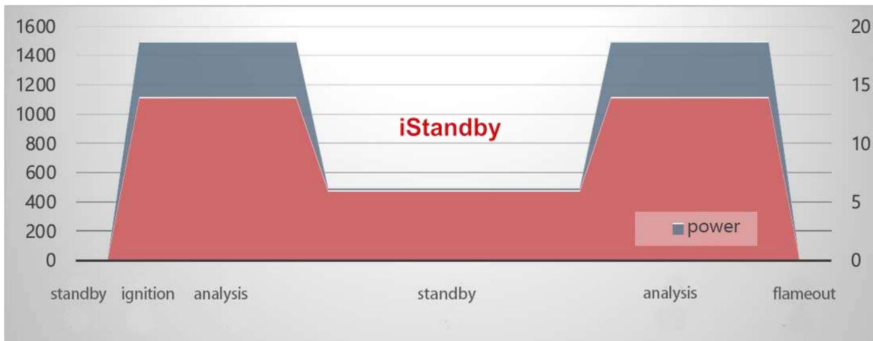
Интеллектуальный режим «ожидания» **iStandby Mode** обеспечивает низкое энергопотребление в интервалах между анализами и значительную экономию потребления аргона, с автоматическим возвратом к нормальным рабочим условиям с началом ввода образца
