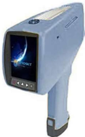
**Анализируемые элементы:** 83 элемента от Mg до Pu.
