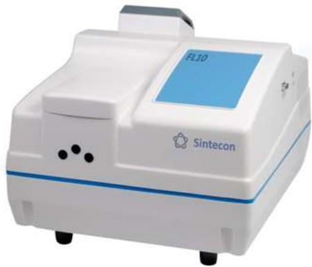
**Sintecon FL10** – спектрометр среднего класса для молекулярного люминесцентного анализа жидкостей, пластин и порошков.
