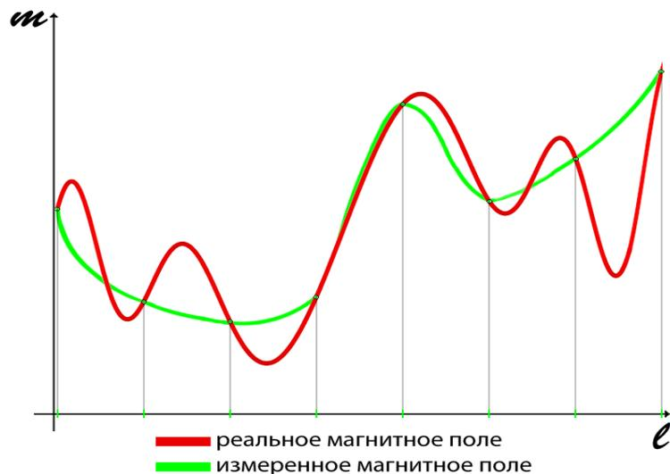
Сравнение индукции магнитного поля «реального» и наблюдаемого менее точным, высокочастотным магнитометром по 100 точкам
