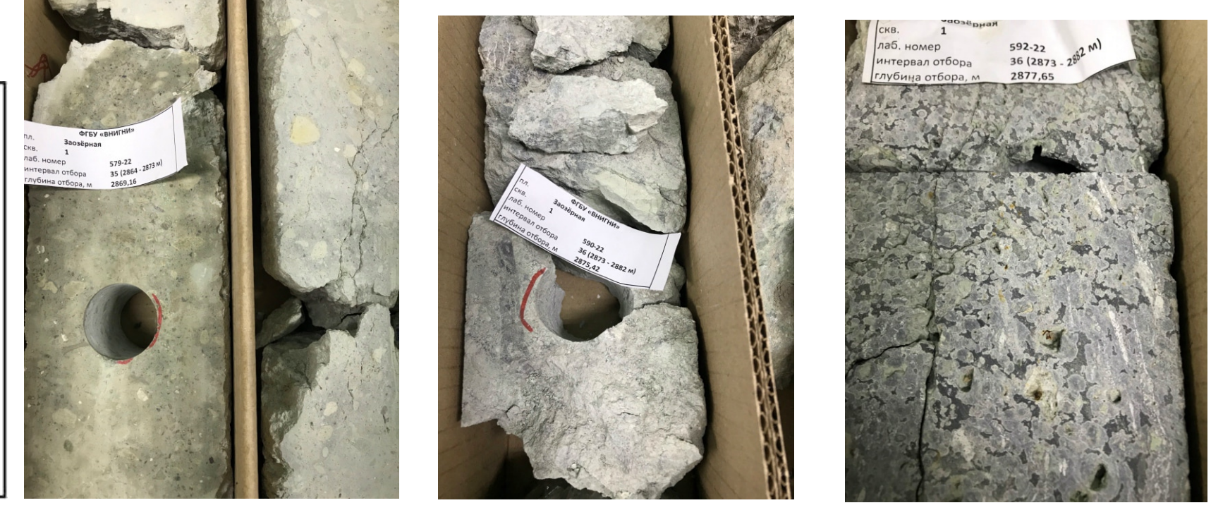
Образцы керна с повышенными фильтрационно-емкостными свойствами из интервала глубин 2864,7 - 2878 м (объект 2)
