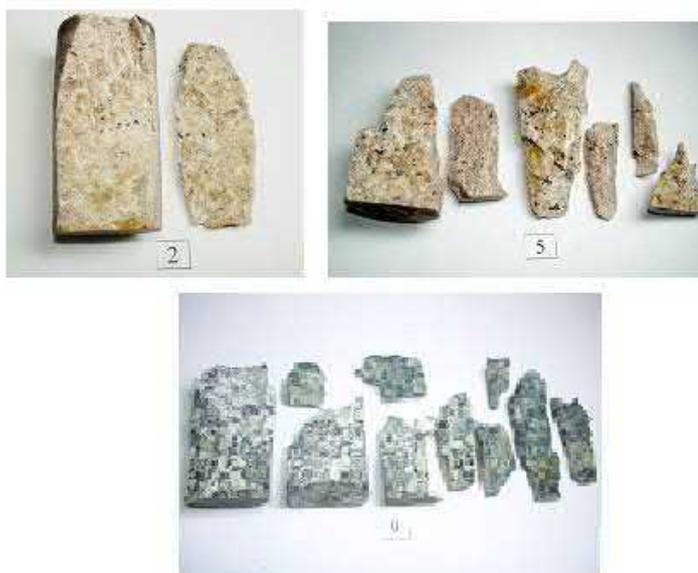
Рис. 2. Фотографии образцов керна гранита после разрушения:
