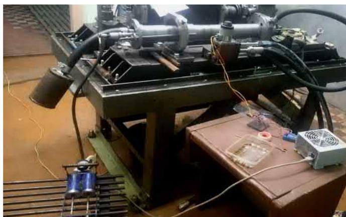
Рис. 3. Стенд с гидроударной машиной.
