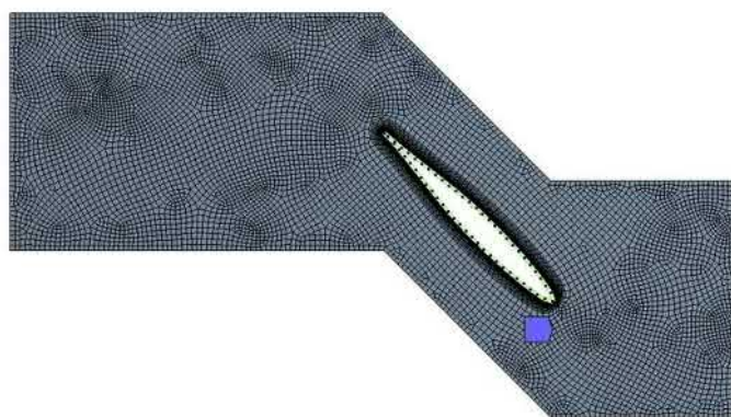
Рис. 1. Участок решётки с профилем NACA 65-010 с контрольными объёмами
