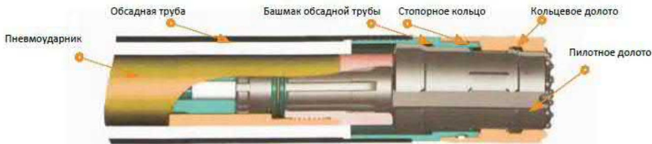
Рис. 3. Snряд для бурения с одновременной обсадкой системы Symmetrix
