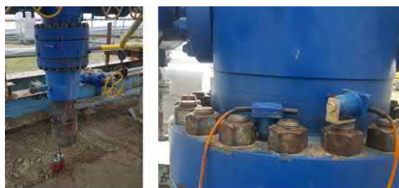
Рис. 1 Вертикальные и горизонтальные геофоны GS-20DX и одноканальные автономные цифровые регистраторы Texan (RefTek-125A) на кусте колонны газовой скважины.
