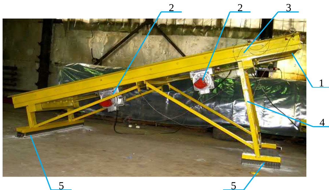
1 – рабочий орган; 2 – инерционный вибровозбудитель; 3 – рама; 4, 5 – вертикальный и упругий опорный элемент соответственно
