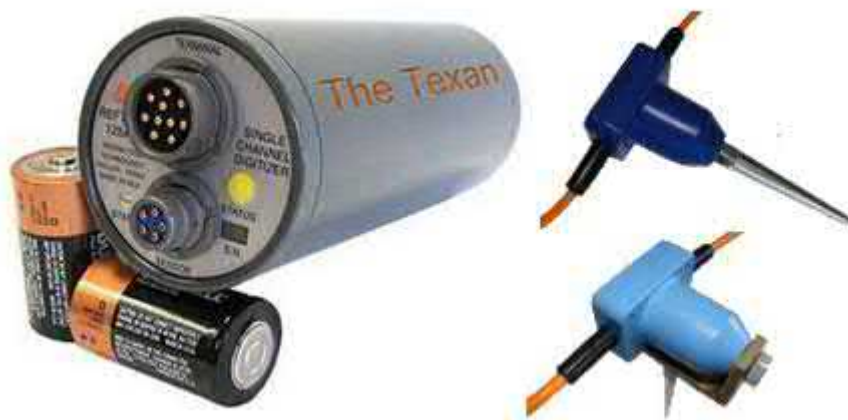
Рис. 1 Вертикальные и горизонтальные геофоны GS-20DX и одноканальные автономные цифровых регистраторов Texan (RefTek-125A)
