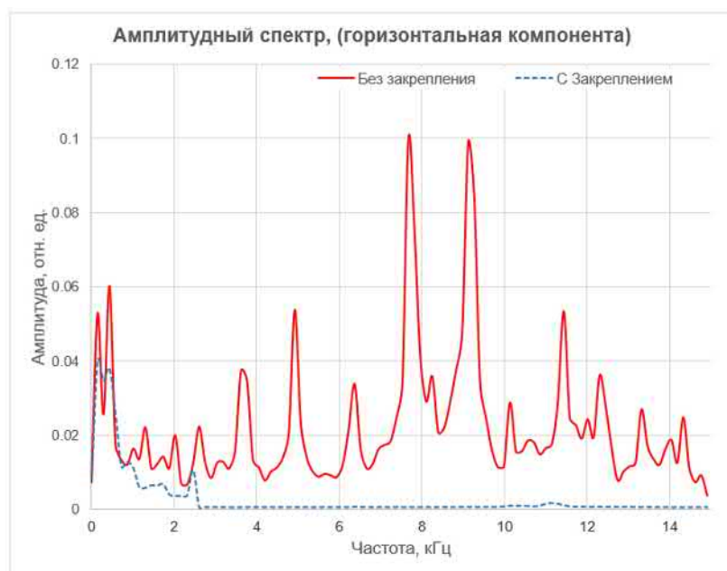
Рис. 5 Наличие или отсутствие квазирегулярных пиков изгибных мод, свидетельствующее о качестве закрепления макета КГС
