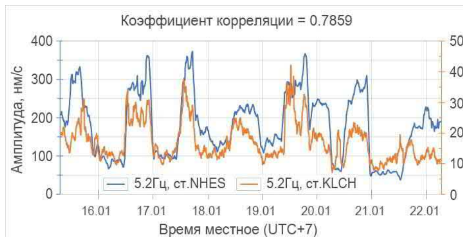
Рис. 4. Графики изменения амплитуд колебаний на частоте 5.2 Гц, полученные на сейсмостанции НГЭС (синий) и Ключи (оранжевый) с 15 по 22 января 2021 г. Z-компонента
