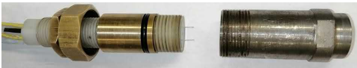
Рис. 1. Датчик измерителя сопротивления в разобранном виде
