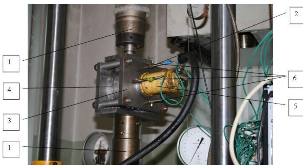
Рис. 1. Устройство для испытаний на сдвиг образца горной породы при действии нормальной сжимающей силы:
