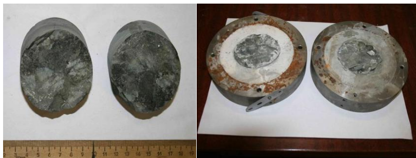
Рис. 2. Фотография образца туфопесчаника до и после испытания
