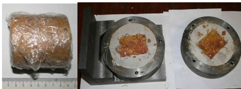
Рис. 3. Фотография образца глинистой коры выветривания до и после испытания
