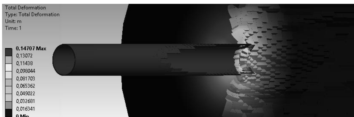
Рис. 2. Распределение деформаций в грунтовом массиве при погружении трубы
