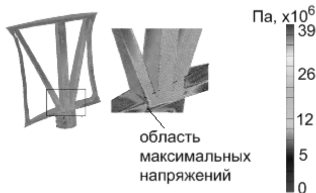
Рис. 2. Область максимальных напряжений в сердечнике лопатки с древовидной структурой
