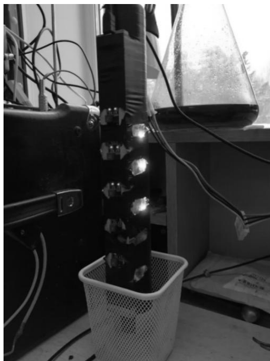
Рис. 3. Блок регистрации объема профильтрованного газа
