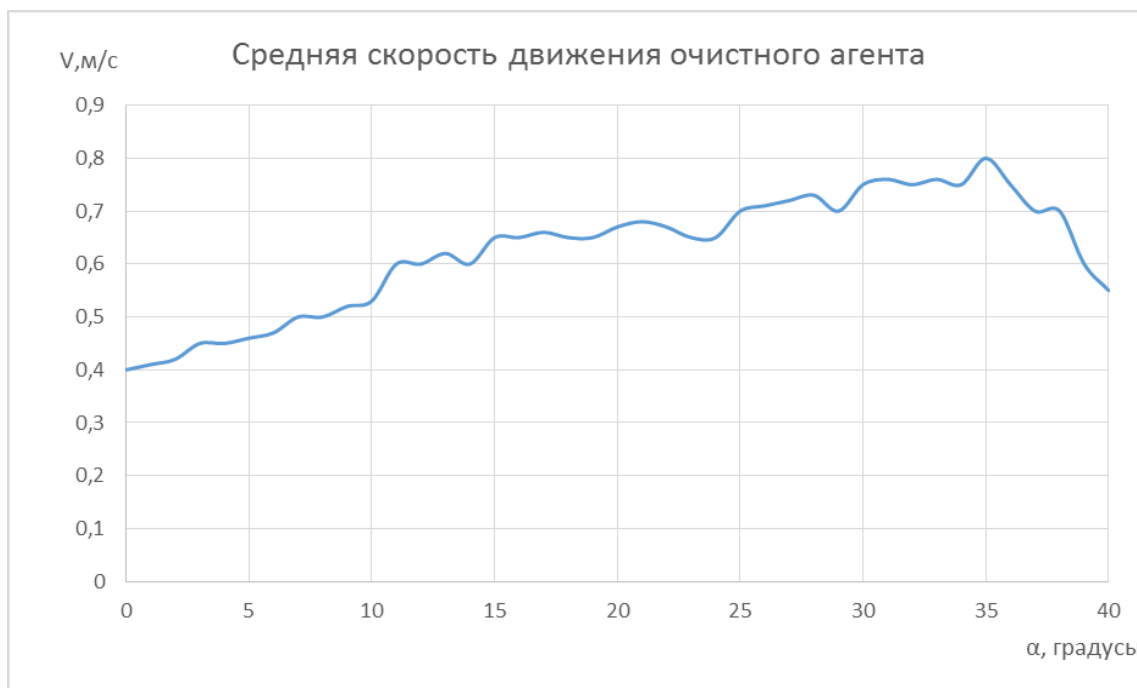
Рис. 6. Зависимости средней скорости движения очистного агента в забойной зоне от угла \alpha
