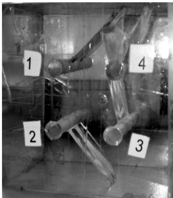
Рис. 5. Модельный образец с трещинами после гидроразрыва при использовании двустороннего зонда:
