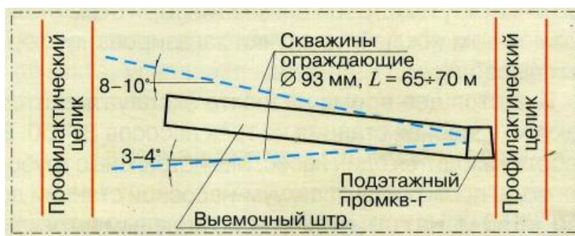
Рис. 3. Схема бурения ограждающих скважин при подготовке подэтажа
