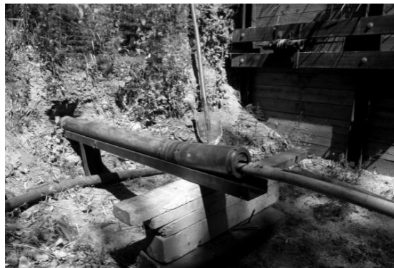
Рис. 2. Испытания пневмопробойника в грунтовом массиве
