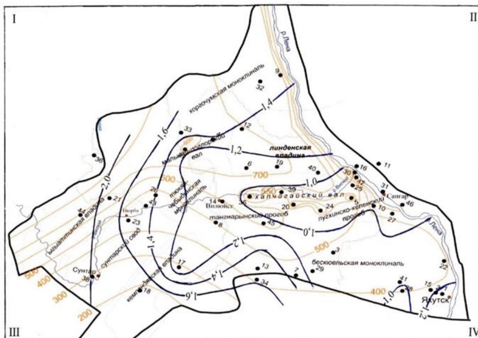
Рисунок 1 - Схема расположения нижней границы ЗСГ метана (черные изолинии, оцифровка в км) в осадочном чехле Вилюйской синеклизы. Желтыми изолиниями (оцифровка в метрах) показано расположение нижней границы криолитозоны (данные ИМЗ СО РАН). Точками с номерами отмечены участки, для которых выполнены оценки расположения границ.
