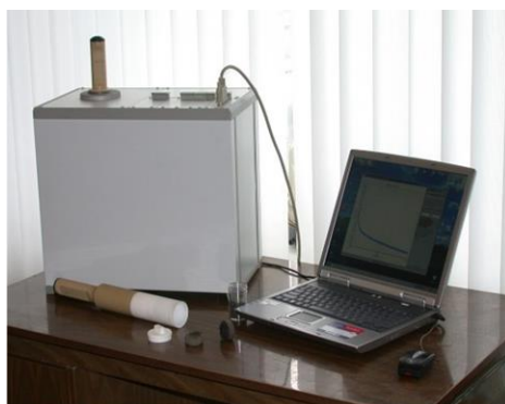
Рисунок 1 – Лабораторная установка с кварцевой ячейкой
