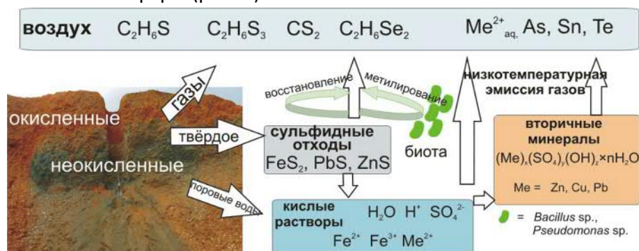
Рисунок 1- Схема формирования и миграции газовых потоков от техногенных тел
