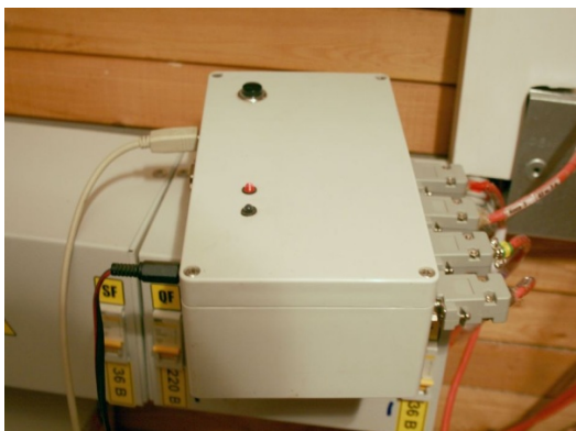
Рис. 1. Внешний вид станции в корпусе с подключёнными датчиками (а) и вид платы со стороны разъёмов для подключения датчиков (б).
