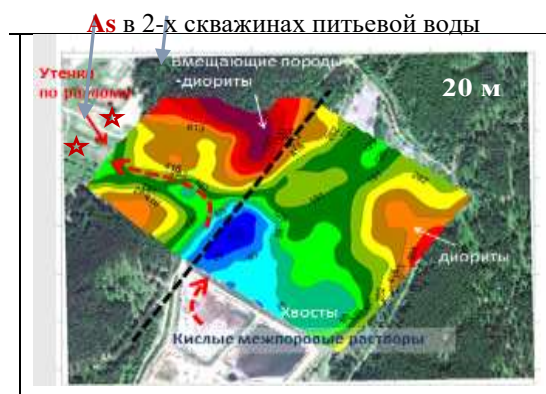
Рис. 1. Направление подземного стока из хвостохранилища по природному разлому: карта распределения УЭС, гл. 20 м.
