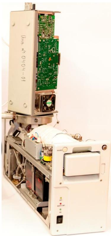
Рис.1.Макет высокочувствительного газового хроматографа ЭХО-СПИП с рекордно низким порогом обнаружения паров тринитротолуола на уровне  $10^{-16}$  г/см<sup>3</sup>.
