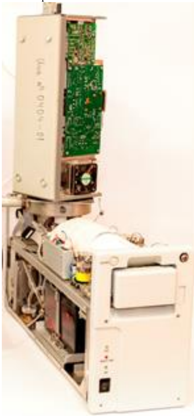
Рис. 2. Макет портативного высокочувствительного экспрессного газового хроматографа ЭХО-СПИП с рекордно низким порогом обнаружения паров тринитротолуола на уровне 10^{-16} г/см 3 .
