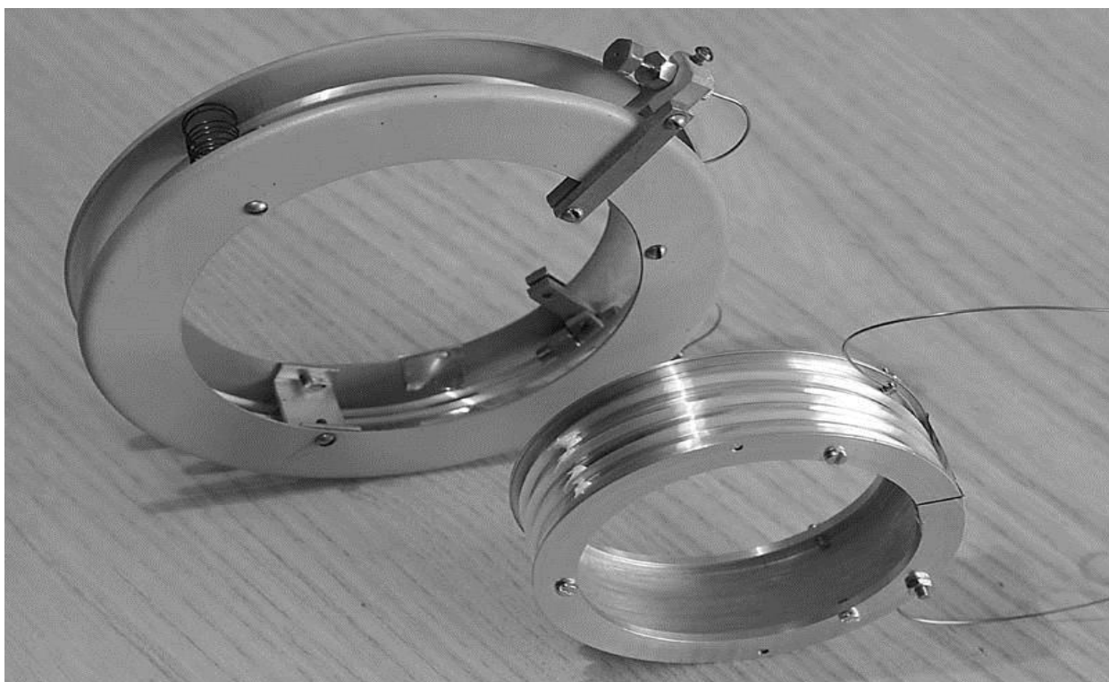
Рис. Фотография обычной спиральной и компактной спиральной поликапиллярной колонки в кассете нового конструктива
