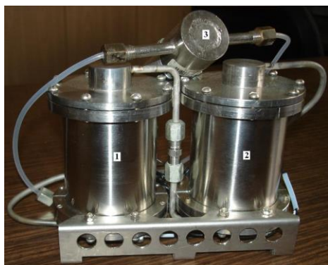
Рис. Блок глубокой очистки воздуха ГХ "ЭХО-В-М". 1 – фильтр с сорбентом ИК-011-1; 2 – фильтр с молекулярными ситами NAX; 3 – датчик измерителя микровлажности газов ИПВТ-07
