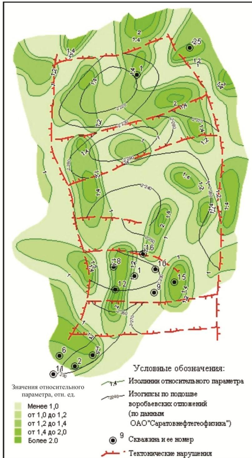
Рисунок 109. Распределение значений относительного параметра V на катоде геоэлектрохимического устройства по результатам анализа элементного состава образцов горных пород на примере Алексеевско-Заветного участка. Масштаб 1:25 000.
