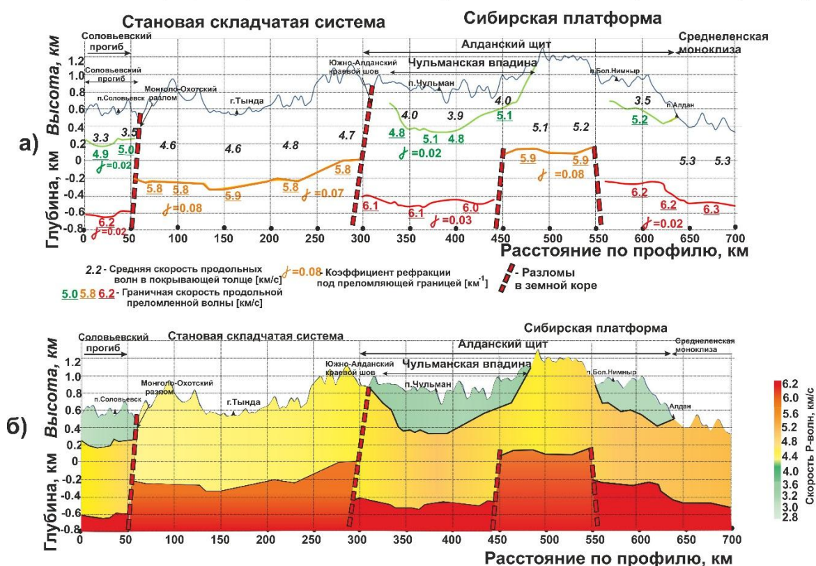
Рисунок 5.1 — Модель скоростного строения верхней части земной коры по продольным преломленным волнам для Южного фрагмента профиля 3-ДВ (система наблюдений ОГТ): а) модель в значениях скорости, б) модель в цвете.
