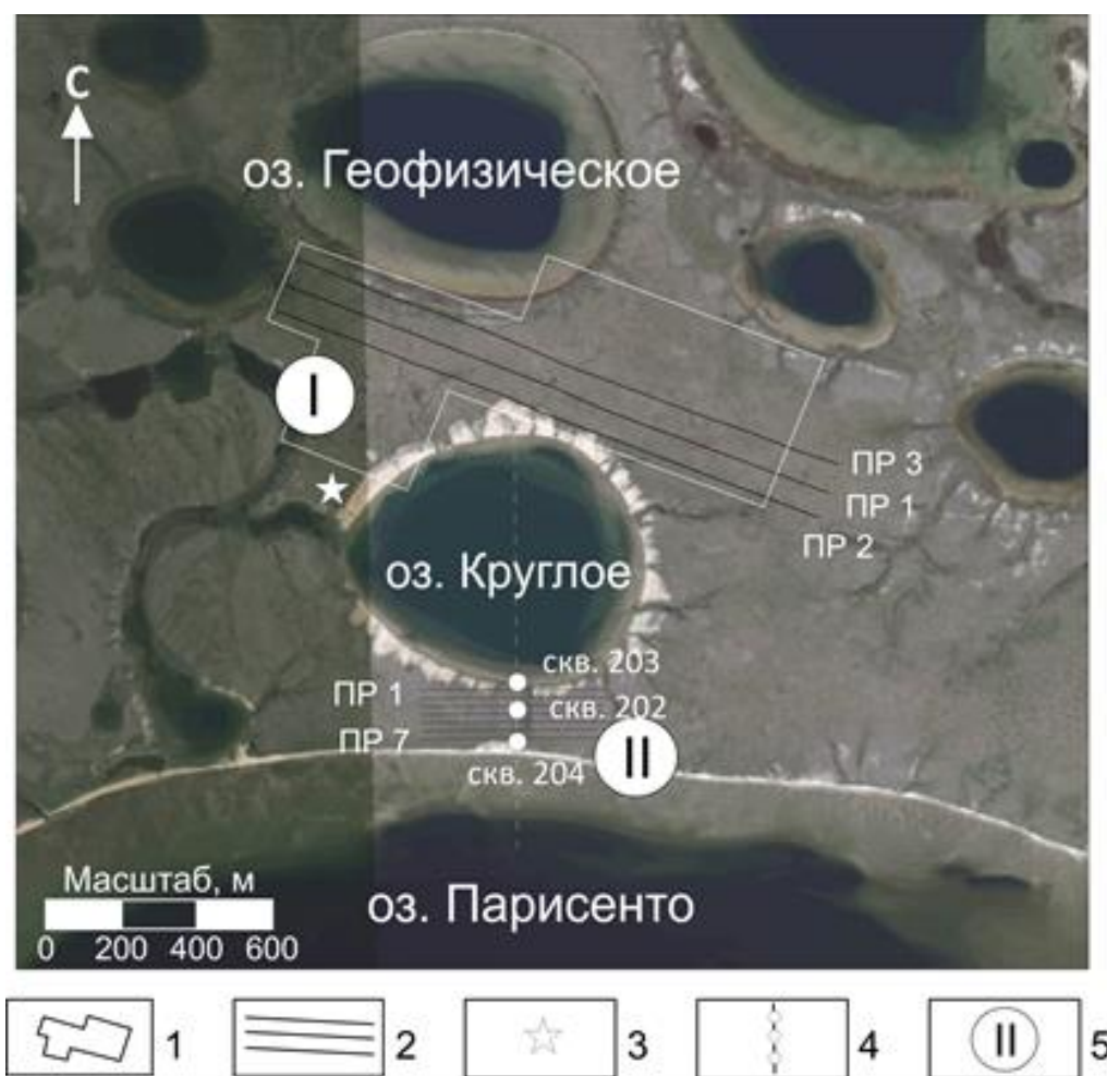
1 – контур площади ЗСБ; 2 – профили ЭТ; 3 – стационар «Парисенто»; 4 – положение скважин № 202, 203, 204; 5 – номера участков исследований.
