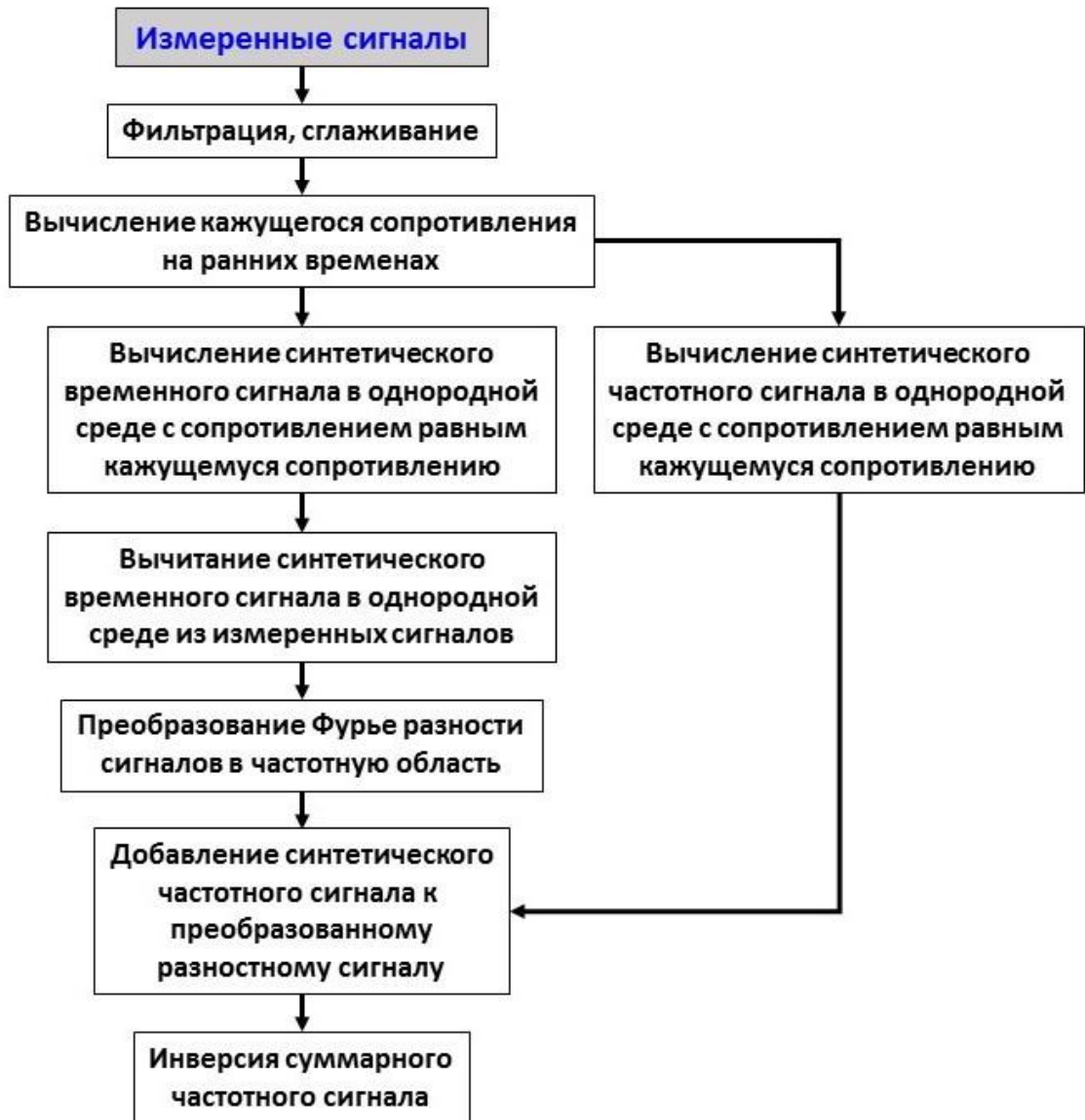
Рисунок 4.7 – Алгоритм преобразования сигналов для последующей инверсии
