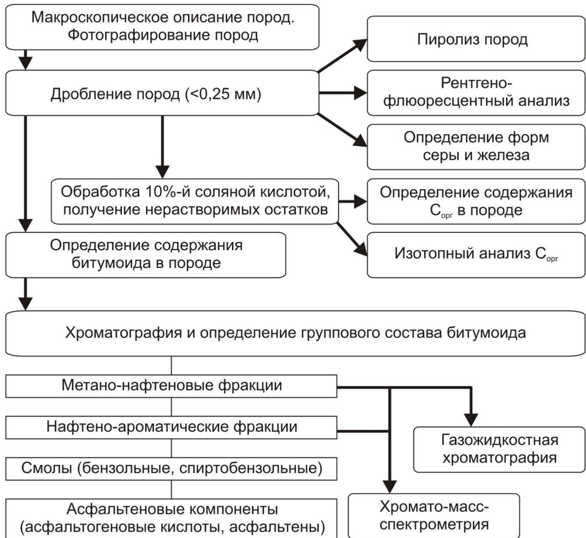
Рисунок 2.2 – Схема исследования пород и рассеянного органического вещества, используемая в настоящем исследовании
