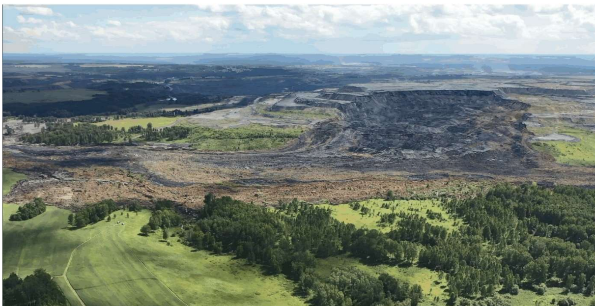
Рисунок 3.14 – Стоп-кадры видеосъемки Елбашинского отвала Колыванского угольного разреза через несколько дней после оползня [ https://youtu.be/KhXGpzuzPCU ]
