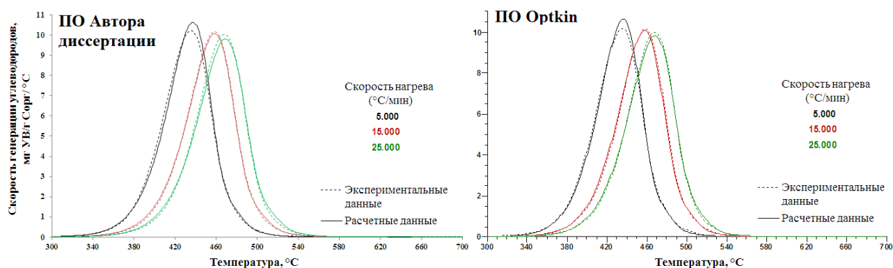
Рисунок 2.6 – Экспериментальные и расчетные пиролитические кривые
