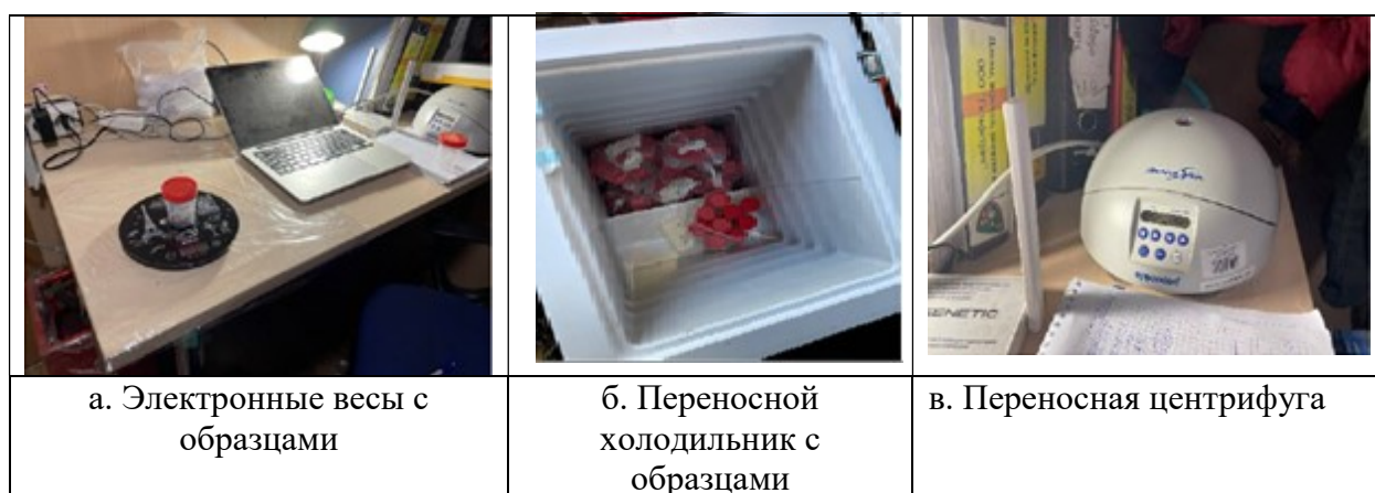
Рисунок 3.6 – Набор оборудования для отбора проб шлама для последующего секвенирования ДНК микробиоты [34]
