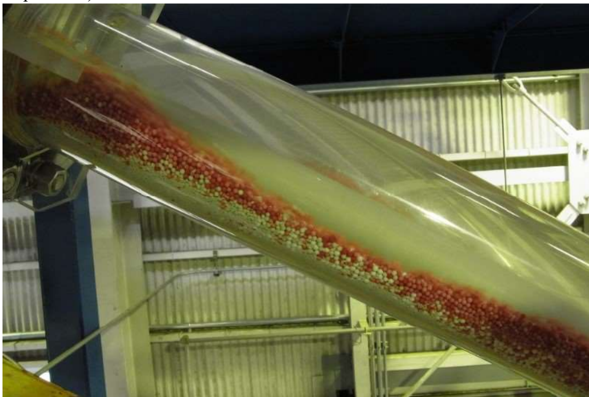
Рисунок 3.2 – Внешняя труба циркуляционной установки для моделирования времени выхода шлама [165]
