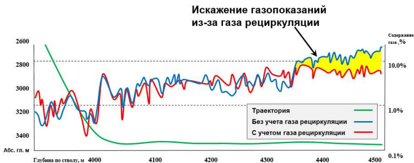
Рисунок 1.12 – Пример влияния газа рециркуляции на газопоказания
