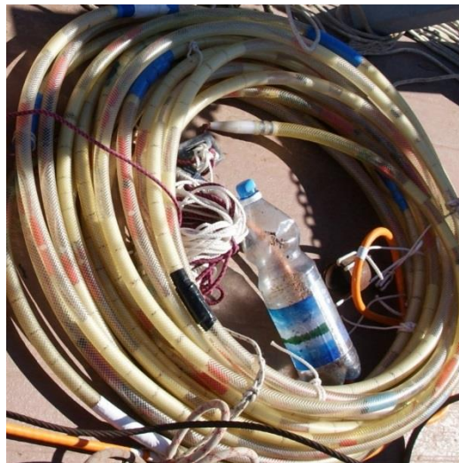
Рисунок 46 – 16-канальная сейсмическая коса.
