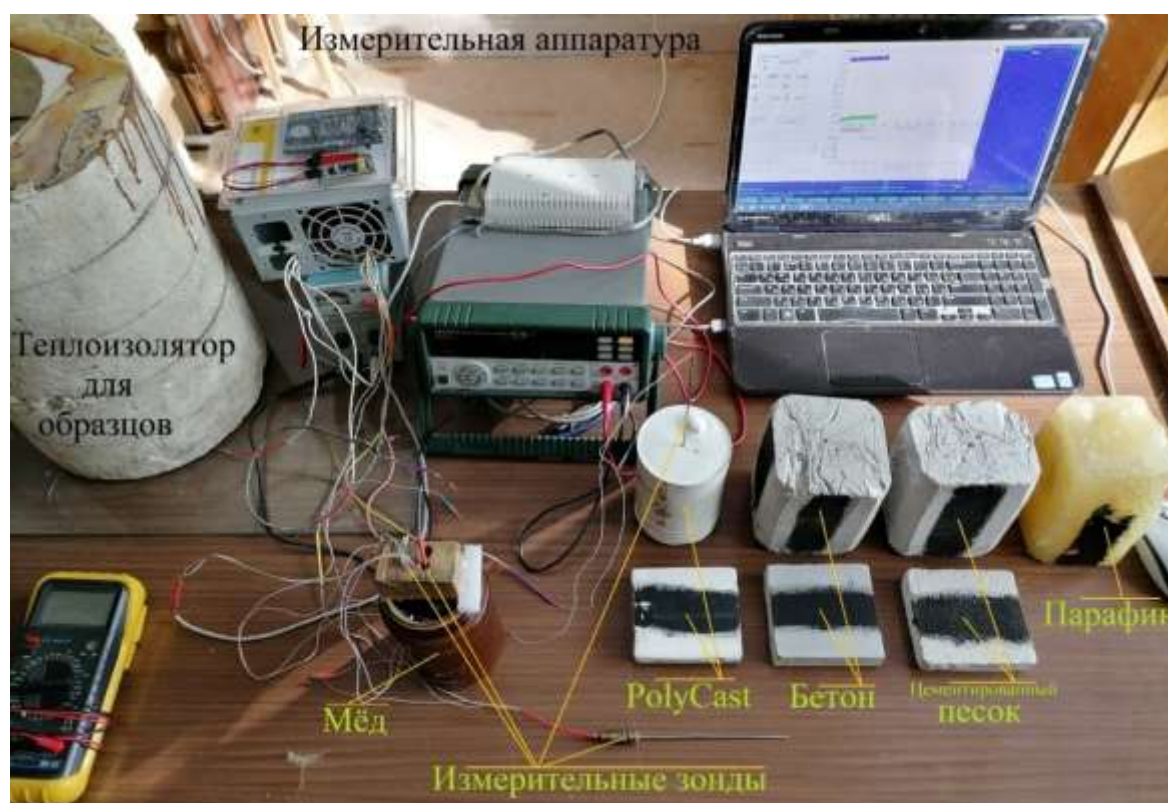
Рисунок 2.14 – Измерительная аппаратура и однородные образцы для тестирования используемой в работе методики измерения теплофизических параметров образцов.
