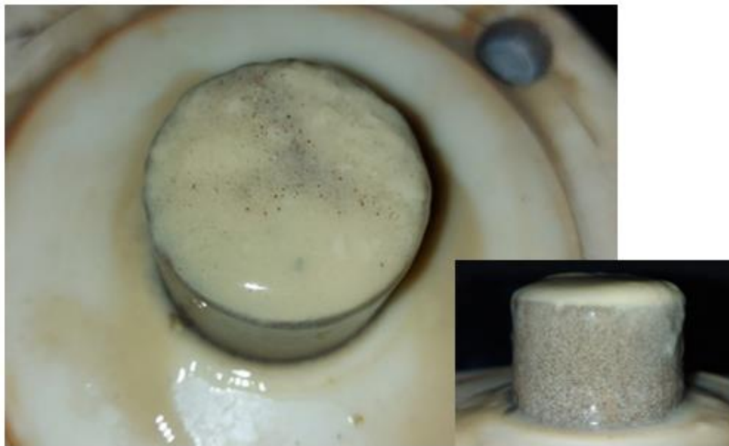
Рис. 3.3.4. Корка, образованная на образце 6225-1 (скважина 122), полимер-карбонатный NaCl раствор
