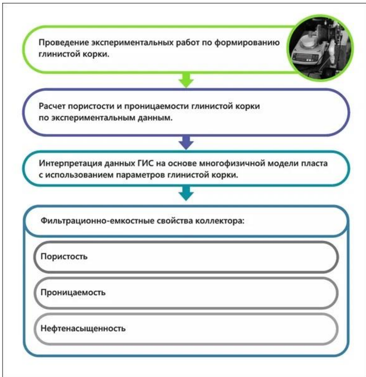
Рис. 3.3.9. Алгоритм учета параметров глинистой корки при построении многофизической модели пласта при бурении с перепадом давления менее 5 атмосфер [Евменова и др., 2022]
