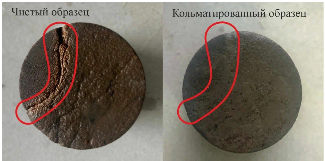
Рис. 3.3.7. Образец перед фильтрацией бурового раствора и после образования зоны кольматации, трещина заполняется глинистыми частицами [Евменова и др., 2023б]
