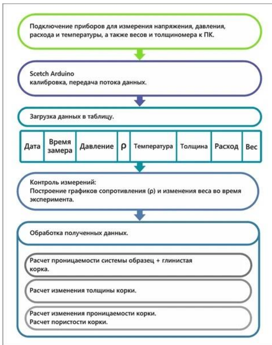
Рис. 3.1.3. Схема передачи и обработки данных эксперимента на ПК
