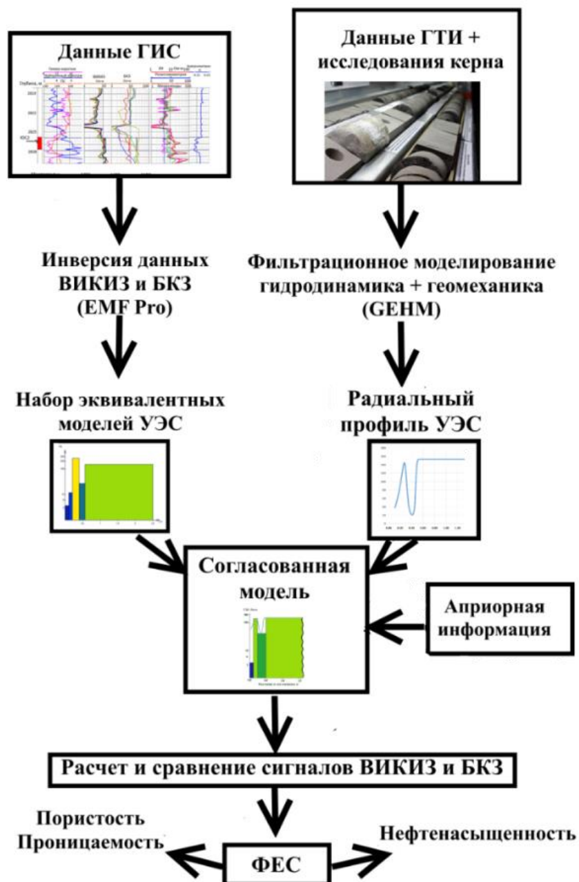
Рис. 2.2.1. Схема интерпретации данных ГИС на основе многофизичной модели пласта [Евменова и др., 2022]
