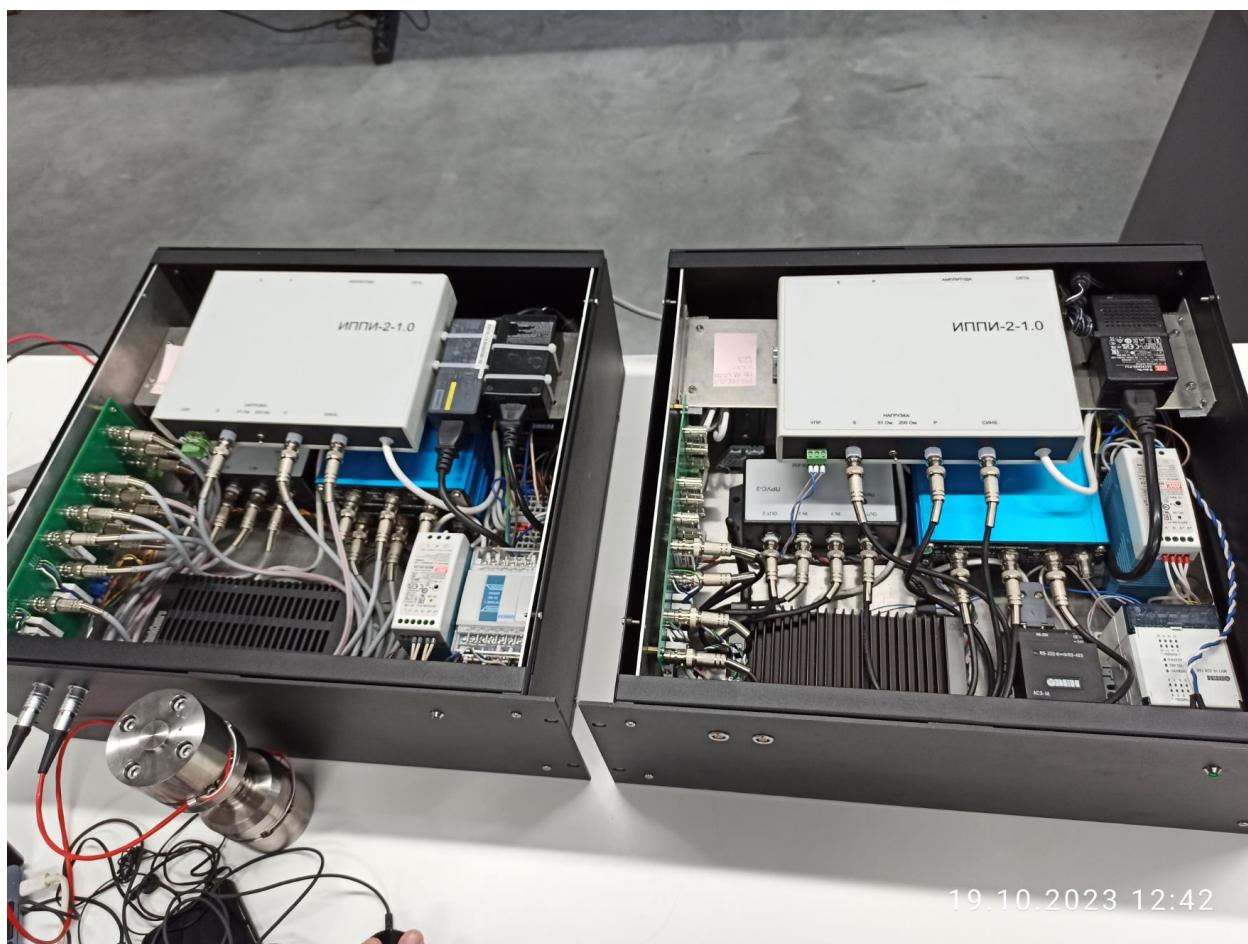
Рисунок 2.13 – Модули различных модификаций для регистрации акустических волн производства ООО «Ситен Технологии».
