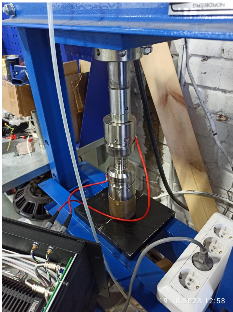
Рисунок 4.5 – Стенд для калибровки датчиков (измерения времени задержки импульса через материал волновода) согласно ГОСТ 21153.7–75.
