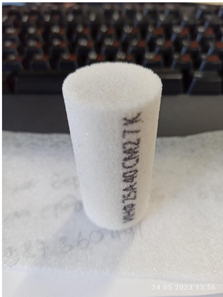
Рисунок 4.7 – Искусственный образец диаметром 30 мм и длиной 60 мм, изготовленный по заказу автора из наждачного камня.
