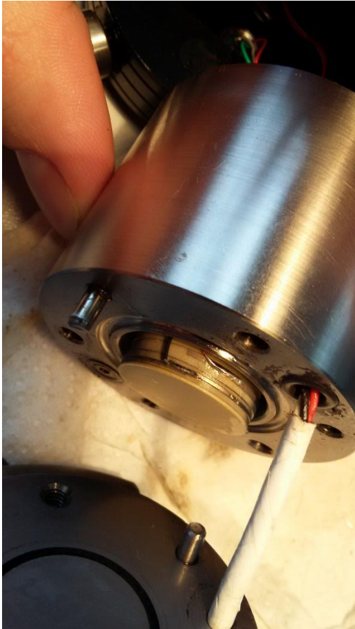
Рисунок 3.3 – Отрыв вертикальной компоновки пьезопластин от волновода на оборудовании Autolab. Волновод находится в нижней части рисунка, оторванная пьезокомпоновка лежит внутри верхней крышки датчика [Анчугов, 2021].
